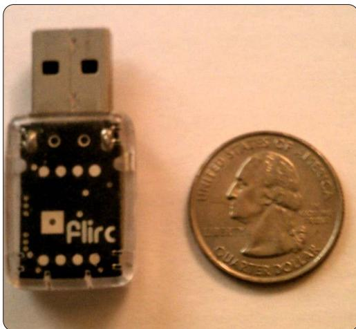
Se avete provato a far funzionare LIRC (Linux Infrared Remote Control) con un telecomando, sapete già che è un'impresa ardua e probabilmente non avrà funzionato. Ecco che Flirc viene in soccorso.
