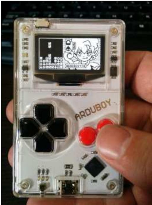
À l'intérieur, il utilise un AT MEGA 32U4 avec un écran OLED SSD 1306.
