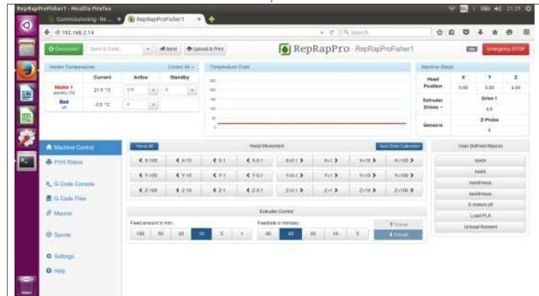
chauffeur et de voir si nous pouvons extruder du filament fondu. Ceci peut être fait en utilisant le lien « Heater » (Réchauffeur), en haut à gauche. Quand il atteint la température sur la liste déroulante (190, voire 200+), nous pouvons essayer d'utiliser le dévidoir manuel sur l'extrudeur pour obtenir un peu de plastique fondu.
