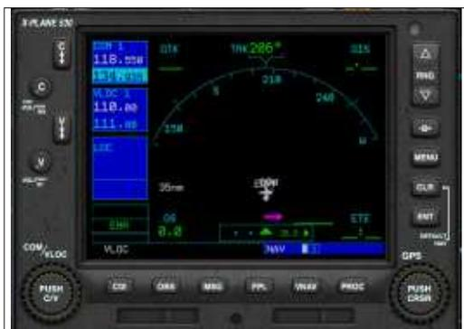
Malheureusement, le Garmin/X-Plane 530 est un peu difficile à utiliser, car il n'a pas de touches. Tout doit être fait en utilisant les deux cadrans rotatifs de chaque côté en bas. Comme les boutons radio, il y a une molette extérieure plus grande, et une molette intérieure plus petite. Chacun dispose également d'un bouton poussoir au milieu.
