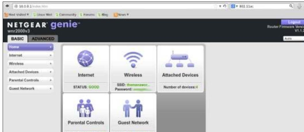
Le impostazioni in Advanced > Advanced setup consentono di accendere e spegnere l'antenna wireless sia completamente che con la pianificazione, e creare una access list wireless. Il WNR2000 può funzionare anche come access point. Questa funzione permette di stendere un cavo dalla porta ethernet standard di un router fino alla porta WAN del WNR2000, funzionando come access point. Il router WNR2000 può anche funzionare come ripetitore, aumentando effettivamente il segnale in un'altra stanza.
